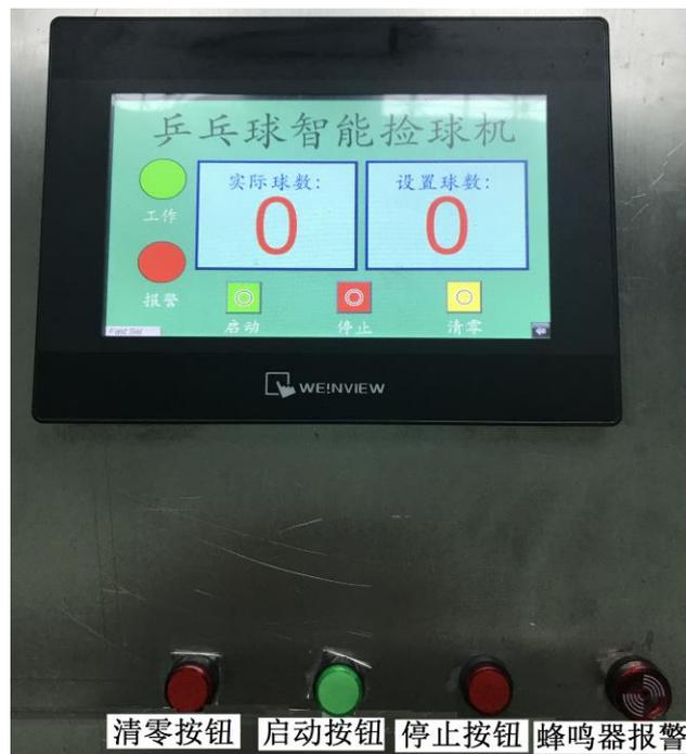
图 7.2 乒乓球智能捡球机操作面板图
