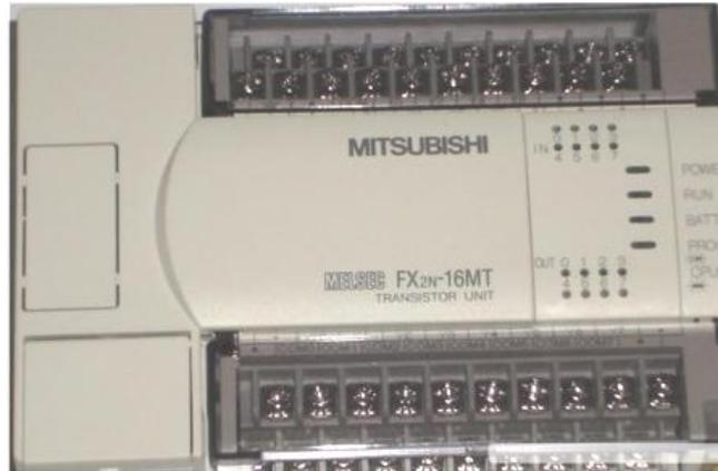
图 4.7 三菱 FX2N-16MT PLC 实物图
