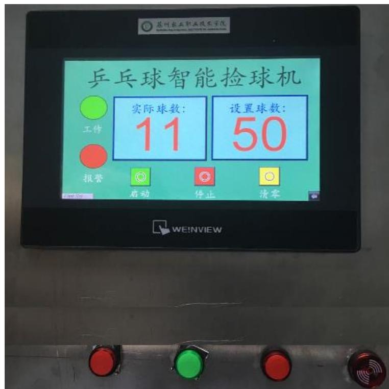
图 6.6 捡拾 11 个乒乓球时乒乓球智能捡球机触摸屏人机界面图
